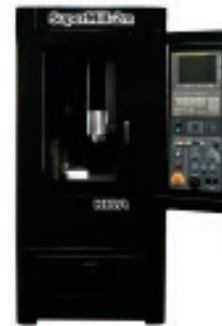
5万回転(標準)、 12万回転(オプション) の高速主轴を搭載
